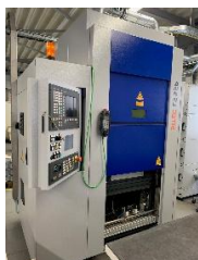
1 Laserschweissanlagen Sitec LS 55P
