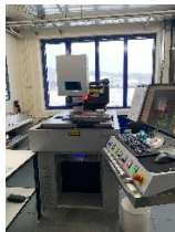
3 Laserbeschriftungsanlagen Acsys Piranha II KR Pico 8W / 12W
