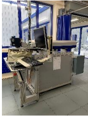
2 Laserbeschriftungsanlage Alfa Laser SK90 Lampenlaser
