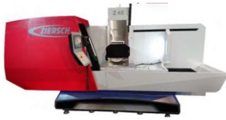
1 Flatschleifmaschine, Ziersch Z48 Schleifbereich 800 x 500 mm
