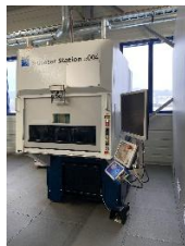
4 Laserschweissanlagen Trumpf TruLaser Station 5004
