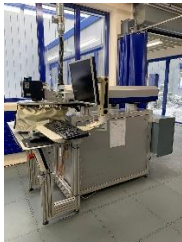
3 Laserbeschriftungsanlagen Alfa Laser SK62 Faserlaser
