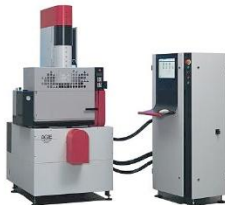
1 Senkerodiermaschine, AGIETRON Spirit 2 mit 4-fach Elektrodenwechsler, Verfahrwege X/Y/Z 300x250x250 mm, Pinole rotierend 0-55 U/min. mit C-Achse
