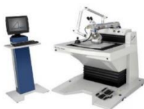
2 Laserschweissanlagen Alphalaser AL-TW 450-F (wassergekühlte Faserlaser)
