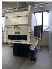
4 Laserschweissanlagen Trumpf TruLaser Station 5004
