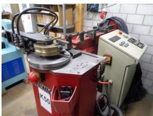
**1 Rohr- und Profilbiegemaschine MEWAG RB42A**
