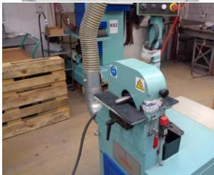
**3 Rohrschleifmaschinen (Finish)**
