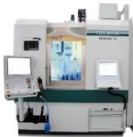
**1 CNC-Vertikal-Bearbeitungszenter, Fehlmann Picomax 90-M**
