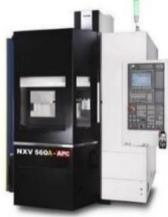
**1 CNC-Vertikal-Bearbeitungszenter, YCM NXV 560 A-APC mit 2-Fach Palettenwechsler**
