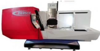
**1 Flachschleifmaschine, Ziersch Z48**
