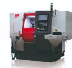
**1 CNC-Drehmaschine EMCO Emcoturn 45 MY**
