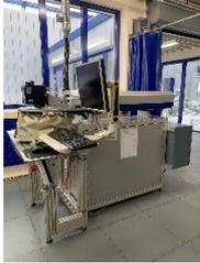
*2 Laserbeschriftungsanlage Alfa Laser SK90 Lampenlaser*
