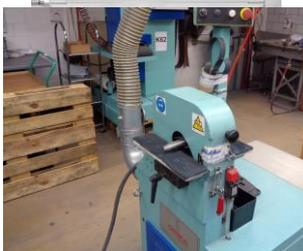
**3 Rohrschleifmaschinen (Finish)**
