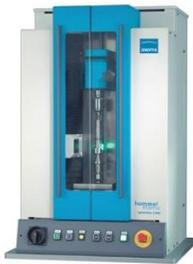
**2 Berührungsloses Wellenmesssystem HOMMEL, JENOPTIC Opticline Contour CS305**
