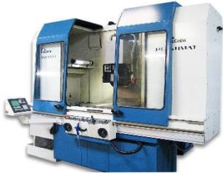
**1 Flachschleifmaschine, Blohm Planomat 608**
