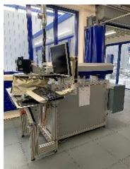
*3 Laserbeschriftungsanlagen Alfa Laser SK62 Faserlaser*
