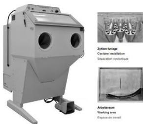
**1 Sandstrahlanlage „Medica“ für die Medizinaltechnik**
