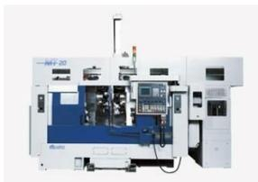
8 Achsen, mit Portal-Laderoboter, Werkstück-Palettiersystem,  $\varnothing$ 170 x 140 mm mit C- und Y-Achsen und 2 x 15 angetriebenen Werkzeugen. Stangendurchlass  $\varnothing$  65 mm, mit Stangenlademagazin LNS Quick Load Servo II / LNS Quick Load Servo III
