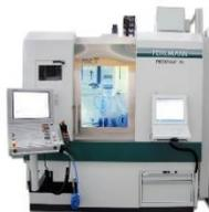
**1 CNC-Vertikal-Bearbeitungszentrum, Fehlmann Picomax 90-M**
