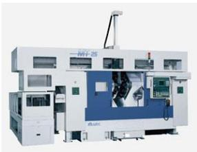
8 Achsen mit Portal-Laderoboter, Werkstück-Palettiersystem,  $\varnothing$  250 x 200 mm mit C- und Y- Achse und 2 x 15 angetriebenen Werkzeugen, Stangendurchlass  $\varnothing$  65 und 75 mm, mit Stangenlademagazin LNS Quick Load Servo II / LNS Quick Load Servo III
