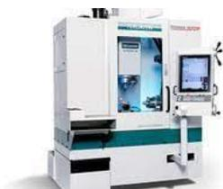
**1 CNC-Vertikal-Bearbeitungszentrum, Fehlmann Picomax 56L Top**
