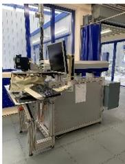
*3 Laserbeschriftungsanlagen Alfa Laser SK62 Faserlaser*
