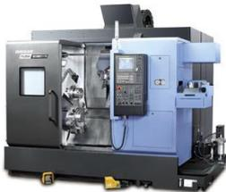
$\varnothing$ 200 x 900mm, mit Y- und C-Achse, schwenkbarer Frässpindel, 40 Magazinplätzen CAPTO C5, unterer Revolver mit 16 Stationen, Stangendurchlass  $\varnothing$ 65mm, mit Stangenlademagazin LNS SPRINT 565
