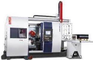
$\varnothing$ 250 x 1'200mm, mit Gegenspindel, beidseitig  $\varnothing$ 200mm Futter, mit Y- und C-Achse, vollwertigen Fräskopf (12'000U/min.) für 5-Achs Simultanbearbeitung (B-Achse), schwenkbar +/-120°, 80 Magazinplätzen (CAPTO 6), unterem Revolver mit 12 Stationen (VDI40), Stangendurchlass  $\varnothing$ 65mm, HD-Pumpe 80bar mit Innenkühlung, Kurzstangenlademagazin Irco-Breuning, Be- und Entladesystem (Werkstückmagazin) für Flanschteile bis  $\varnothing$ 180mm
