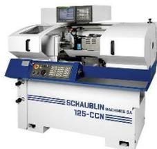
**1 CNC-Hochpräzisions-Drehmaschine „Konventionell plus“, Schaublin 125-CNC**
