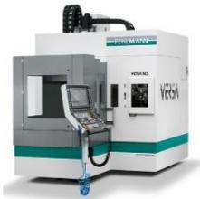
**5 CNC 5-Achsen Bearbeitungszenter Fehlmann Picomax 825 Versa**
