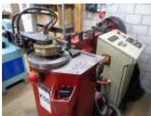
1 Rohr- und Profilbiegemaschine MEWAG RB42A Biegeleistung \varnothing 42 x 2 mm
