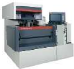
1 Drahterodiermaschine MITSUBISHI FA 10-S Advance Steuerung Mitsubishi Advance M700, 5-Achsen simultan gesteuert, Verfahrwege 350x250x220 mm, Drahtdurchmesser 0,1-0,3 mm, Konik +/- 15°, Feinschlichtgenerator für Oberflächen < 0,1 my Ra
