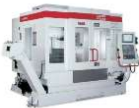
1 CNC 5-Achsen Bearbeitungszenter Quaser MV-204II U Verfahrwege X 700 Y 600 Z 480 mm, Rundtisch D=280, Drehzahl 15'000U/min, mit 3D-Tastsystem und Lasersystem NT, Steuerung Heidenhain iTNC-530
