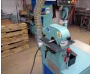
3 Rohrschleifmaschinen (Finish) für gebogene Rohre max. \varnothing 50 mm, kleinster Radius R60
