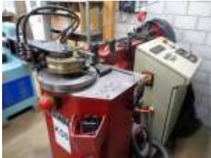
1 Rohr- und Profilbiegemaschine MEWAG RB42A Biegeleistung \varnothing 42 x 2 mm
