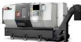
1 CNC-Drehmaschine, HAAS ST-20SSY 4 Achsen, Ein Spindel-Drehmaschine mit Gegenspitz, Ø 230 x 530 mm, C-Achse und Y-Achse 100 mm, Stangendurchlass D=51 mm, Werkzeugrevolver BOT Hybrid mit 24 Stationen, VDI 40
