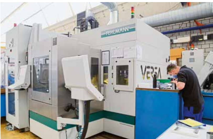
Die Robert Ott AG ist sehr breit aufgestellt. Im Bereich 5-Achs-Fräsen setzt das Unternehmen vor allem auf Bearbeitungszentren von Fehlmann.
